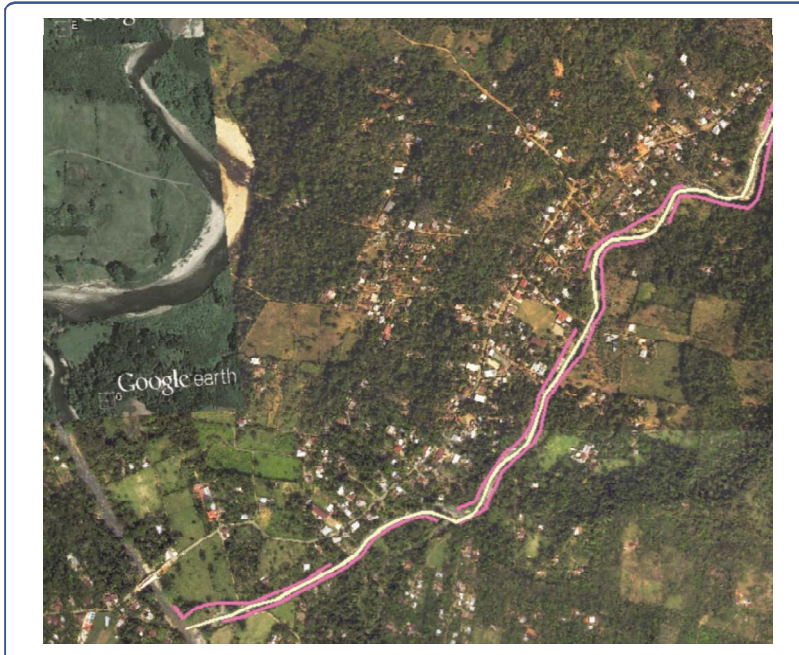
Figura 67. Zonas donde se realizará el cambio de la topografía de la sección por medio de Dragado (Amarillo) y Bordas o Enrocado (Rosado).
