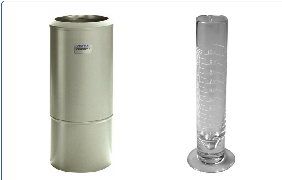
Figura 15. Pluviómetro tipo Hellmann de Lambrecht y probeta graduada para medición de la lámina de lluvia.
