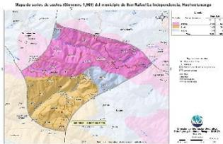
Respecto a las principales características de los suelos, estos provienen de calizas, son susceptibles a la erosión; suelos profundos (Ixcanac) a poco profundos (Acatán y Toquiá) y fertilidad moderada a alta, buen drenaje.
